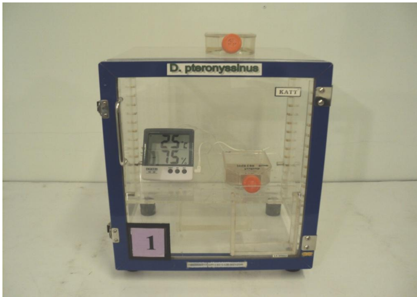
รูปที่ 1 แสดงการทดสอบกับไรฝุ่นที่ความชื้นสัมพัทธ์ในห้องทดสอบที่ 50%RH และในตู้ควบคุมที่ 75%RH ในสภาวะอุณหภูมิและความเข้มแสงที่เท่ากัน
